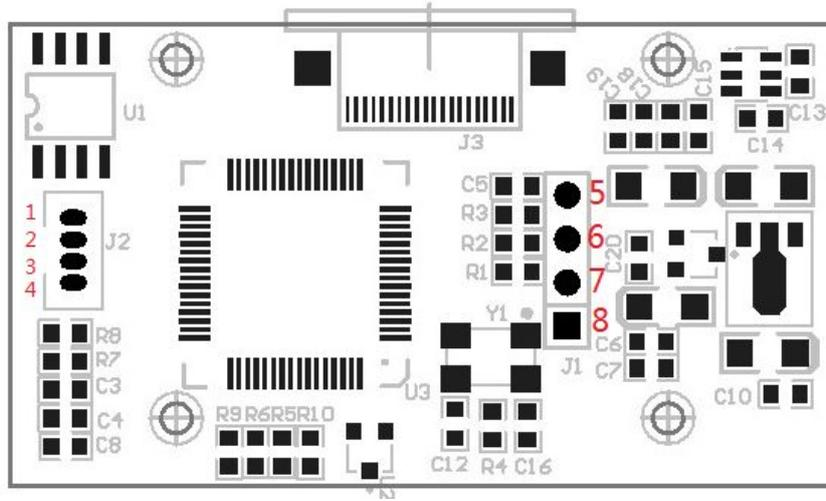
R307 光学式指纹模块电路板
