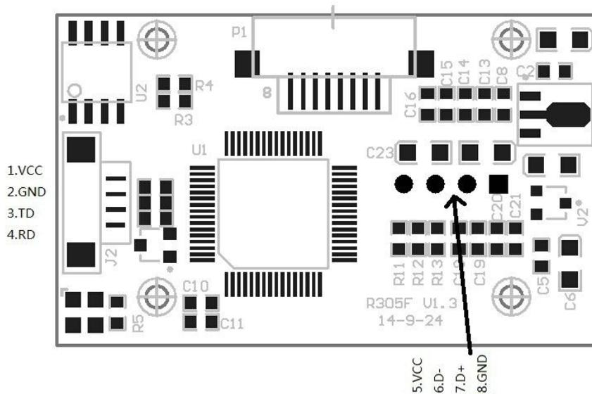
R305T 指纹模块电路板
